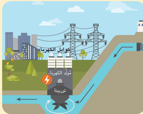
الصورة 1: محطة كهرومائية
