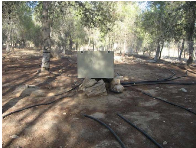
איור 17 אוגר נתונים (DATA LOGGER) של קצב זרימת המים בעצה בעצים המחוברים למכשיר. יער יתיר אוגוסט 2013.
