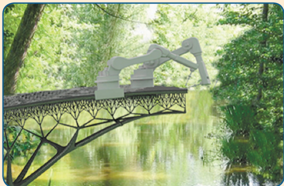
הדמיה של תהליך ייצור הגשר בשטח, במקרה הזה בטבע ובשיטה שבה הרובוטים עובדים זה לצד זה. "מרגע שנצא לדרך ועד שנסיים את ההדפסה אמורים לחלוף שלושה חודשים בלבד, אולי אפילו פחות" צילום: Laarman Joris
