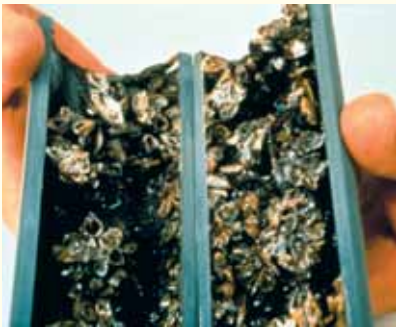
צינור מים סתום בקשוות של צדפת הזברה, מין פולש המסב נזקים של 500 מיליון דולר בשנה בארה"ב
