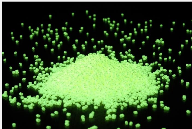
איור 5.3 - דוגמה "לחול" העשוי פלסטיק מעורבב עם חומר פוספורסנטי, הזורח לאחר 'הטענה' באור
