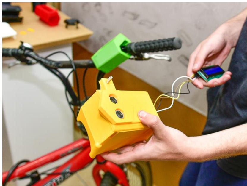
מסך ההתראה, החיישן קדמי ולוח האם.
