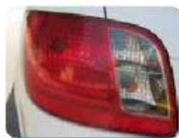
פנס אחורי: אור בלבן, אור נסיעה לאחור, מכוון כיוון אורות זיהוי
