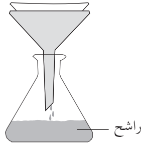
الرسم التوضيحي 2: قنينة عليها قمع مبطّن بورقة ترشيح
