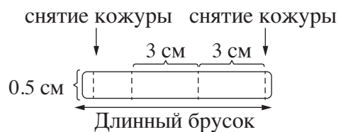
Рисунок 1ד: снятие кожуры и изготовление двух брусков длиной 3 см
