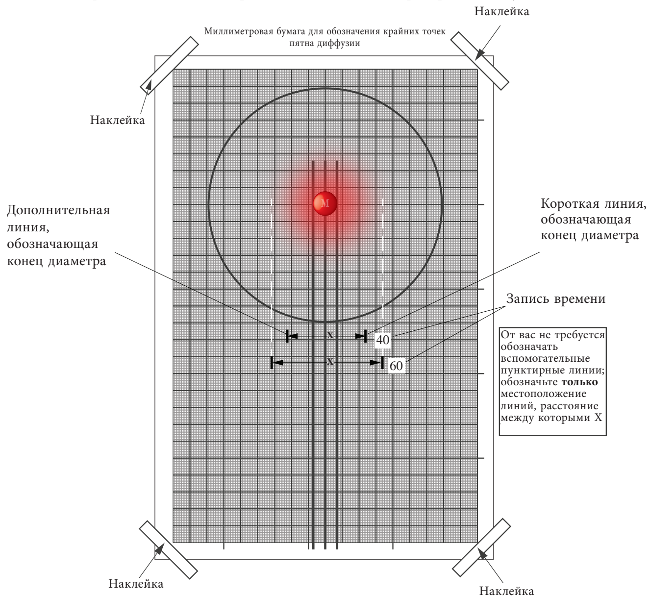
Рисунок Г: пример обозначения концов пятна диффузии в два последовательных момента времени
