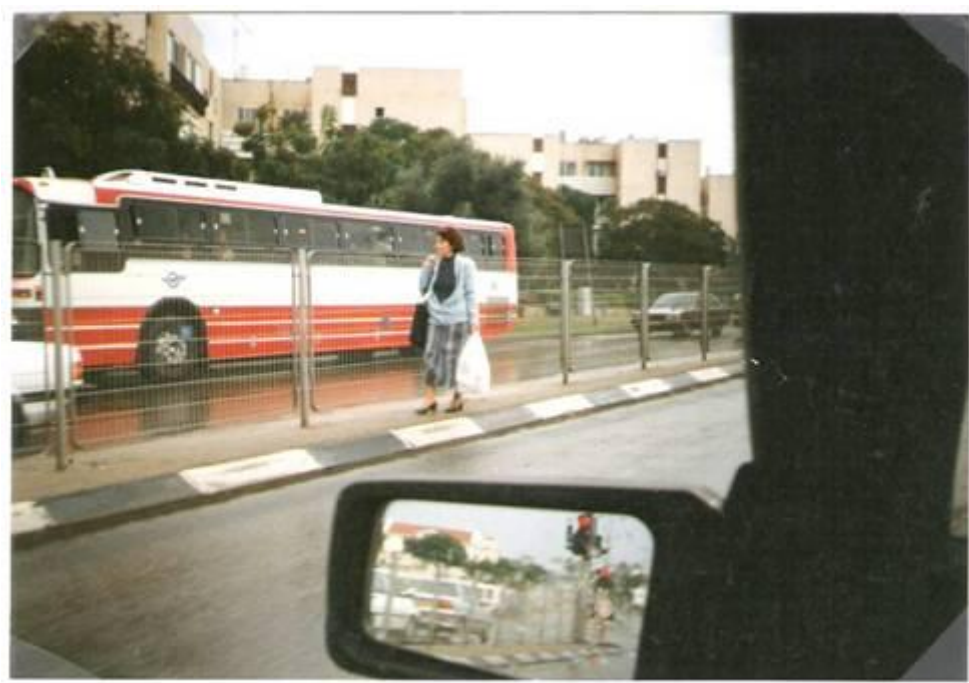
איור 35. כך נראית הולכת הרגל מנקודת המבט של הנהג במרחק של 4-5 מ'. במרחק זה מסגרת השמש יכולה להסתיר אדם בוגר במלואו.
