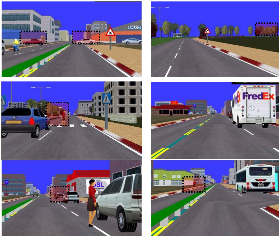
איור 14. תמונות לדוגמא מתרחשי הנהיגה העירוניים. למעלה מימין: עיקול בכביש (תרחיש 8) הריבוע משמש להמחשה להציג מיקום של רכב המוסתר על ידי העיקול, למעלה משמאל: צומת עם תנועה חולפת (תרחיש 9), אמצע מימין: רכב גדול חוסם את שדה הראייה לצומת (תרחיש 10), אמצע משמאל: רכב רחב עוצר משמאל ומסתיר חלקית מעבר חציה בו חוצה הולך רגל מהצד המוסתר (תרחיש 11), למטה מימין: אוטובוס עוצר בתחנה והולכת רגל חוצה לקראתו (תרחיש 12), למטה משמאל: נהגת עומדת להכנס לרכבה החונה מימין ובמקביל רכב חונה מתפרץ לנתיב הנסיעה. כל הסימונים בתרחשים לשם המחשה ולא הופיעו בתרחשי הנהיגה בסימולטור.
