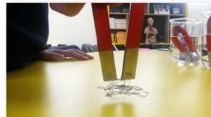
תמונה 3: סיכות מהדק אחת הנמשכות למגנט שנמצא בטמפרטורה גבוהה
