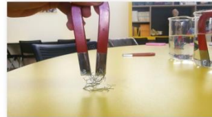
תמונה 2: מספר מועט של סיכות מהדק הנמשכות למגנט שנמצא בטמפרטורה בינונית
