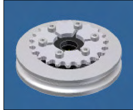
בתמונה ניתן לראות את השרטוט של הגלגלת, כאשר היא מחוברת לגלגל שיניים של 22 שיניים (פירוט מערכת זו בהמשך).
