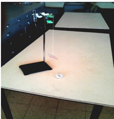
איור 1: (צילום: ד"ר שלמה פישר) אטב ממוגנט תלוי ולידו מצפן רגיל (שימו לב לדמיון עם הוורסריום המקורי שביחידת האלקטרוסטטיקה, מתקן זה בהחלט יכול לשמש בתפקיד זה)
