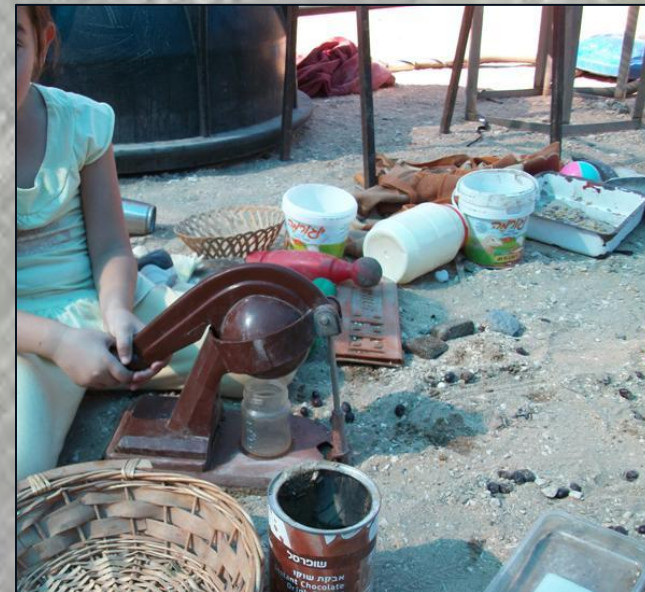
בתחתית המכשיר מניחים בקבוק קטן ולוחצים חזק את הידית כלפי מטה. כל הנוזלים יורדים לתוך הבקבוק.
