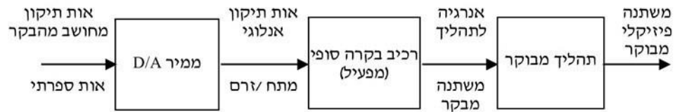
איור 7.6: תרשים מלבנים של מערכת להפעלת רכיבים אנלוגיים
