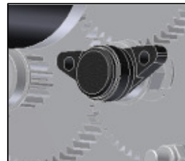
חיבור הEncoder לגיר המנוע, ומערכת שלבי ההפחתה
